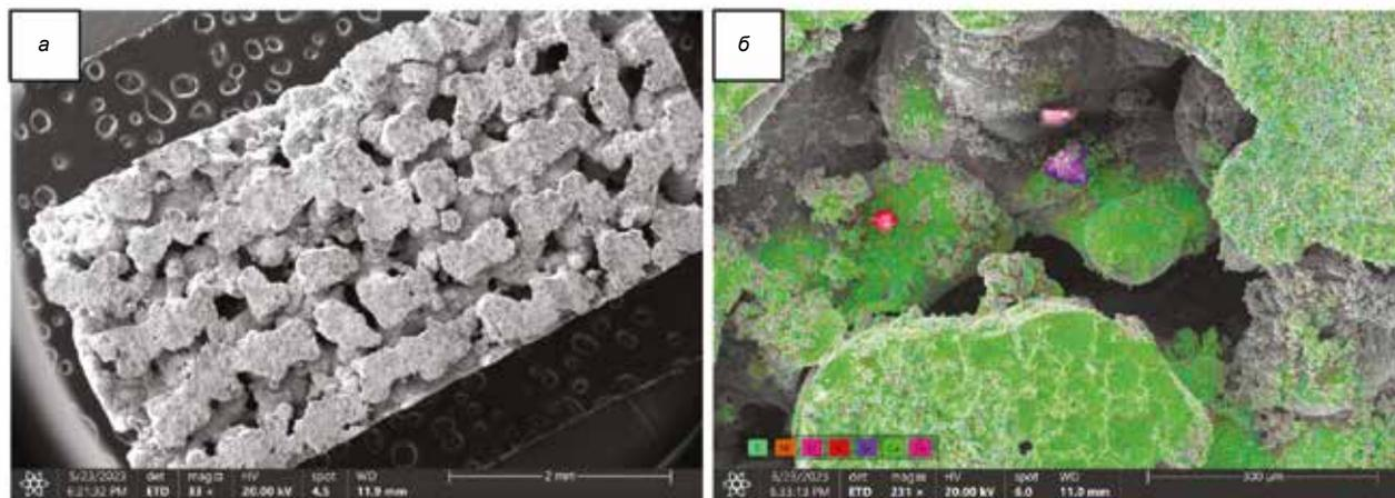
Рис. 1. РЭМ-изображение образца TiNi (а), ЭДС-картирование по элементам образца TiNi (б)
