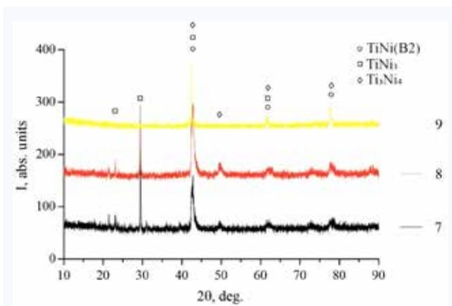
Рис. 2. Рентгенограммы пористого образца, полученного методом селективного лазерного плавления
