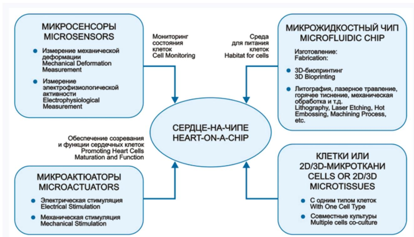
Рис. 2. Принципиальная схема «сердца-на-чипе» [13]
