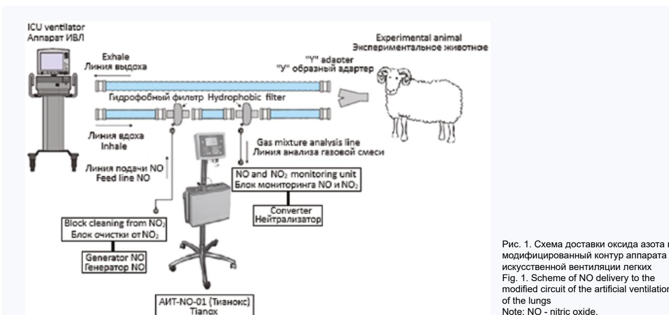
Рис. 1. Схема доставки оксида азота в модифицированный контур аппарата искусственной вентиляции легких
