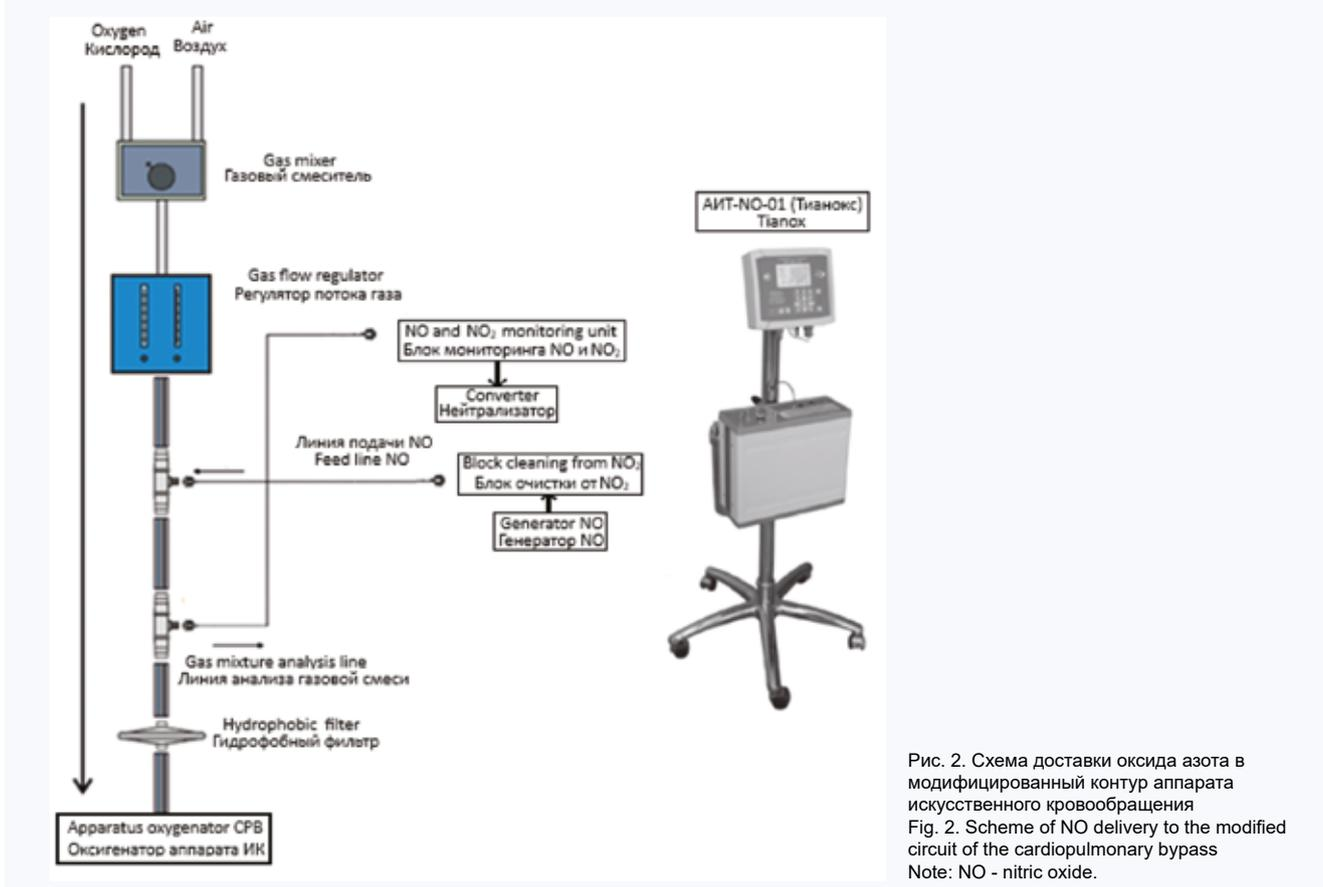
Рис. 2. Схема доставки оксида азота в модифицированный контур аппарата искусственного кровообращения
